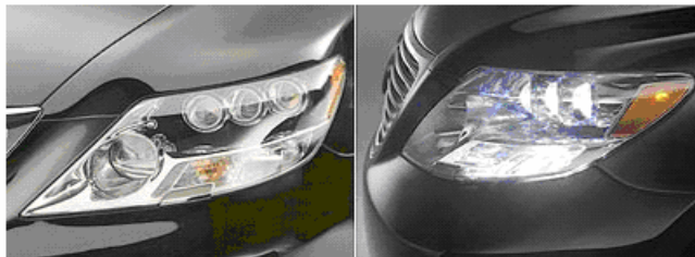
圖(22) 2007年5月豐田所發表最新一款的混合動力車 LEXUS LS600h，在頭燈方面正式引用LED作為光源。
